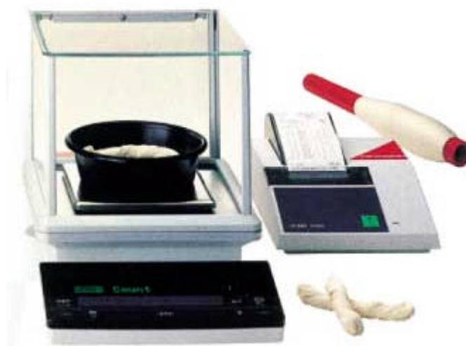
Dovendo determinare la massa lineare del filato secondo le altre varianti previste dalla norma le ulteriori apparecchiature che si rendono necessarie sono le seguenti.
